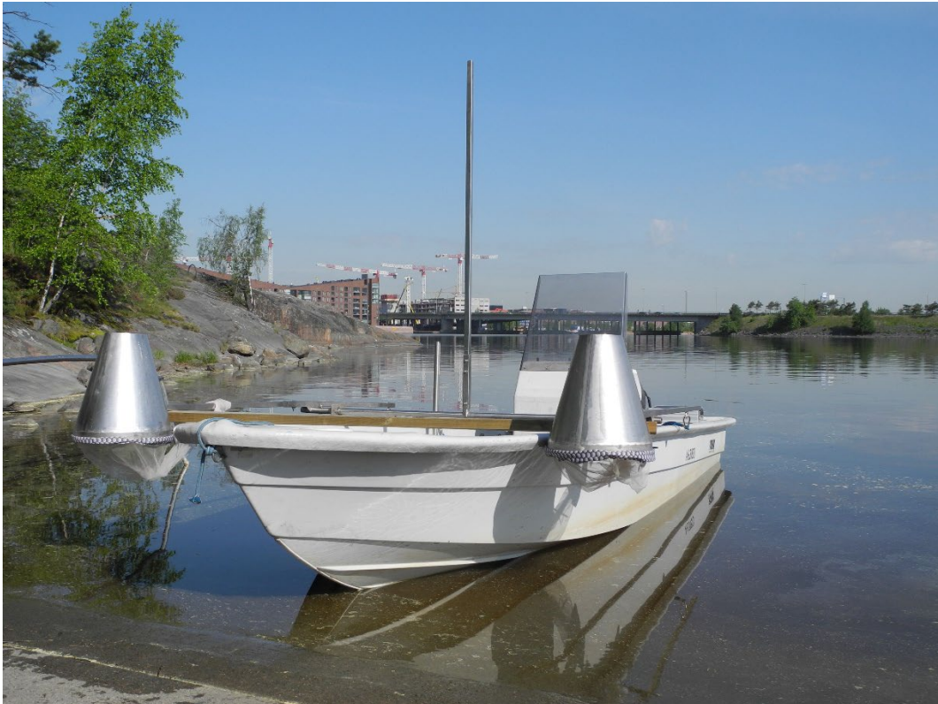
Kuva 3. Gulf Olympia -pyyntilaitte asennettuna veneeseen. Pyyntilinjalla haavit lasketaan veteen. Kuva: Kala- ja vesitutkimus Oy.
